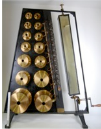
Analyseur à flammes manométriques de Koenig : premier analyseur spectral du son
