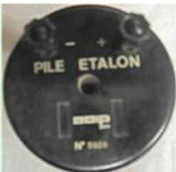
AOIP Pile étalon au cadmium
