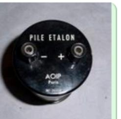
AOIP Pile étalon au cadmium
